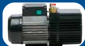
BOMBA ALTO VACÍO Caudal 230 l/min (14m 3 /h) y nivel de vacío final 2 x 10 -2 mbar (15 micrones)
